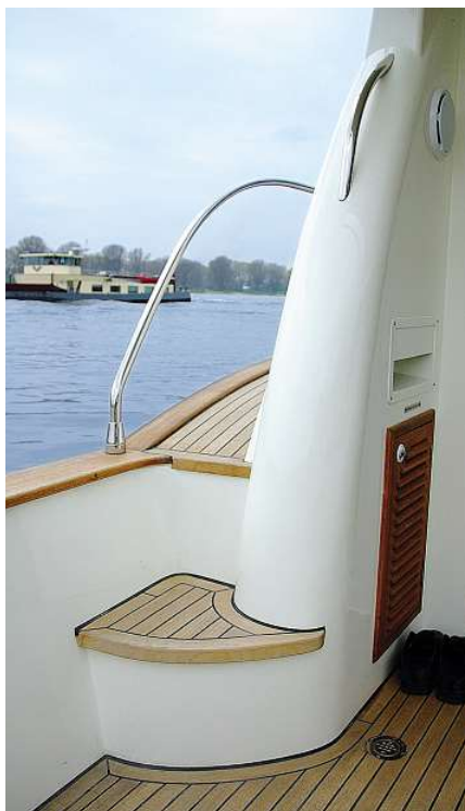
Breite, mit Teakholz belegte Stufen führen auf die sicher begehbaren Gangborde
